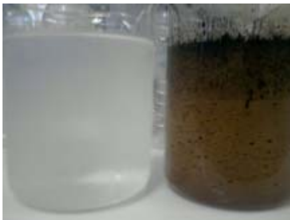
Figura 3 - Comparação do efluente tratado com o efluente bruto.
