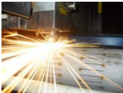
Figura 9 - Processamento dos Rasgos (Slotteds)
